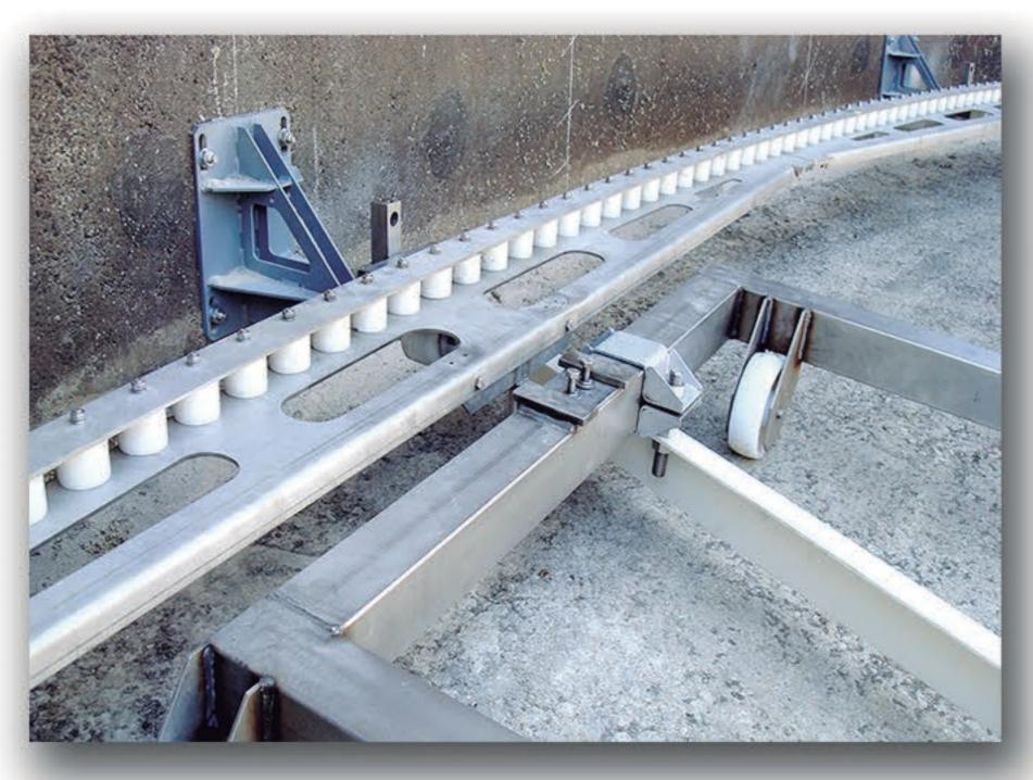
L'anneau de roulement coulisse au bout d'un guide support auto-ajustable
