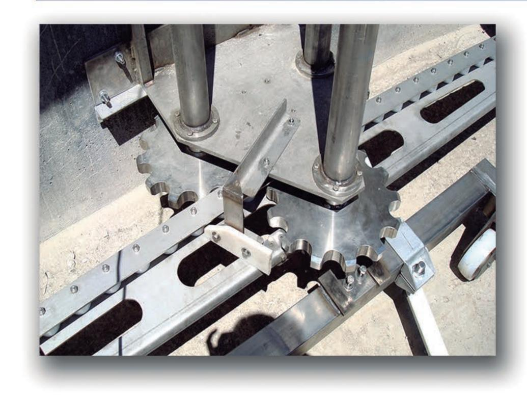
Le système de traction breveté de nos modèles garantit une totale stabilité de la rotation de l'anneau de roulement grâce aux 3 engrenages du moteur.
